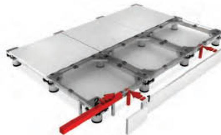
قرار دادن فریم بر روی سیلندر قابل تنظیم .
